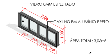
DETALHE JANELA DE ALUMÍNIO ESC:
